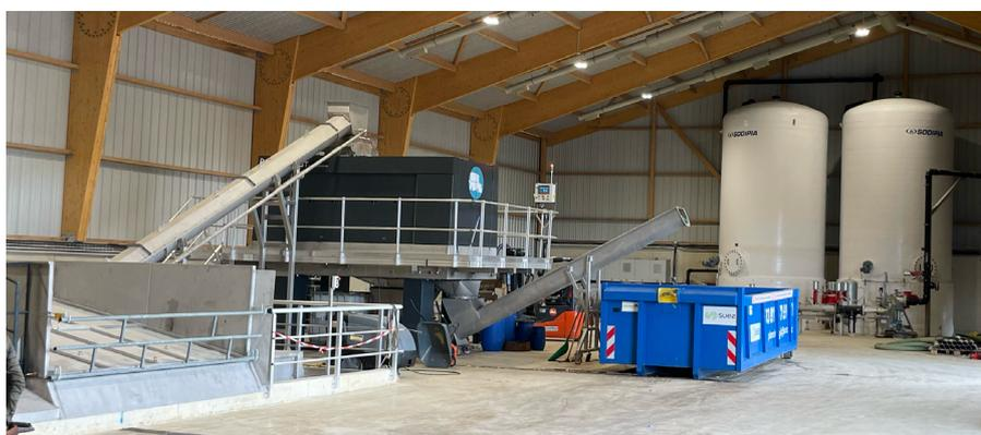
Exemple de chaîne de déconditionnement (trémie + déconditionneur)
