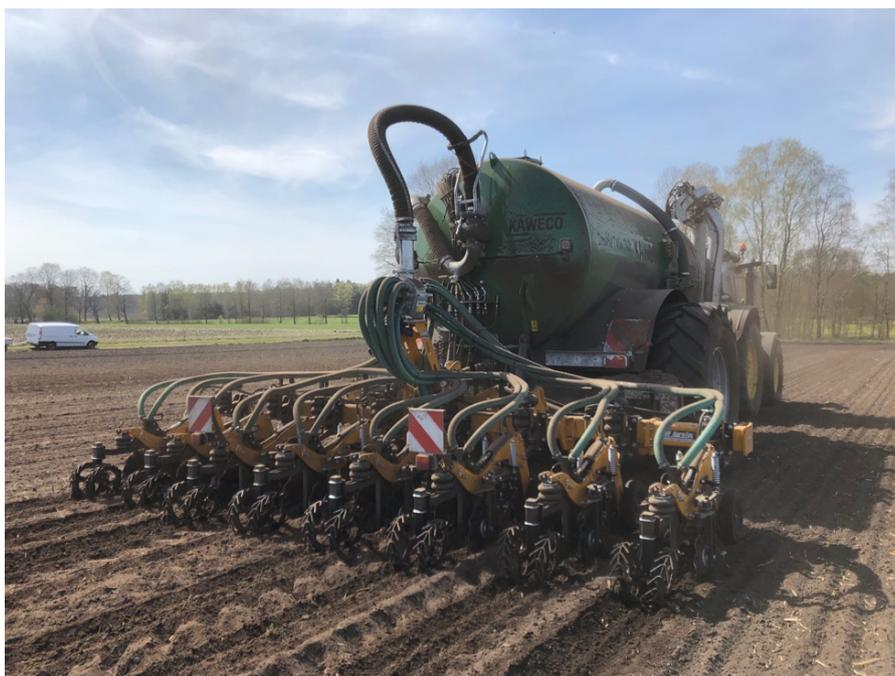
*Épandage digestat liquide avec un enfouisseur à disque*
